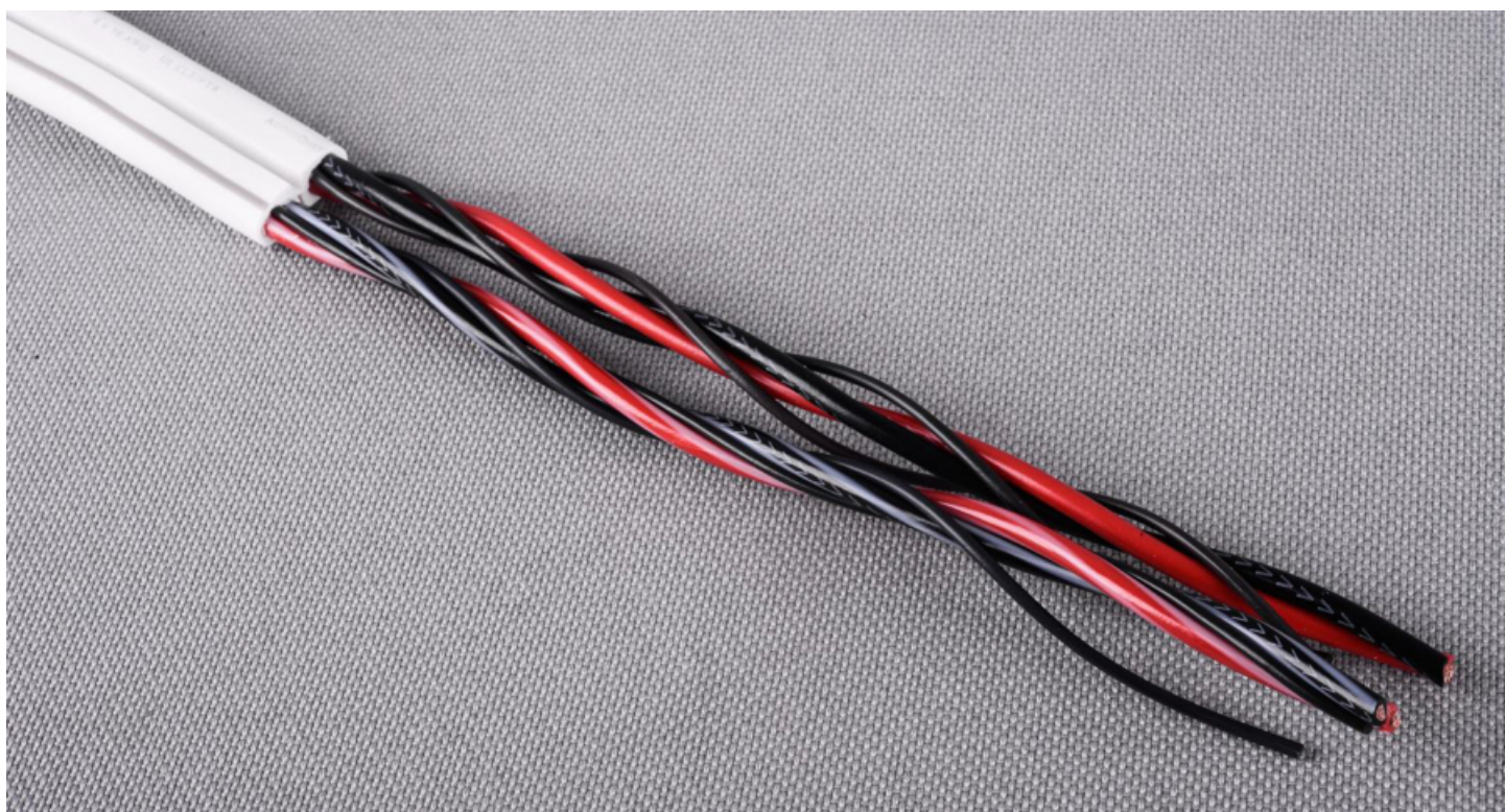
Verwijder de PVC buitenmantel.
